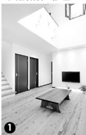
▲開放感を出すためにオープンな間取りにした。収納を適所に配置し、室内はすっきりとしている。吹き抜けは、風の通路にもなっている
